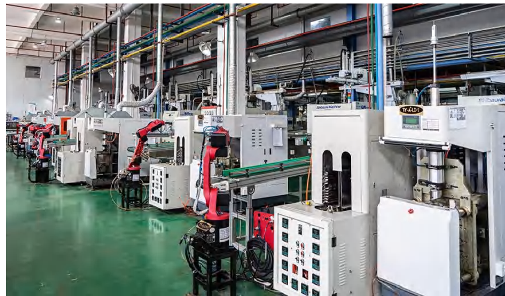
● 注拉吹二步法，配全电动注塑机以及六轴机械人
