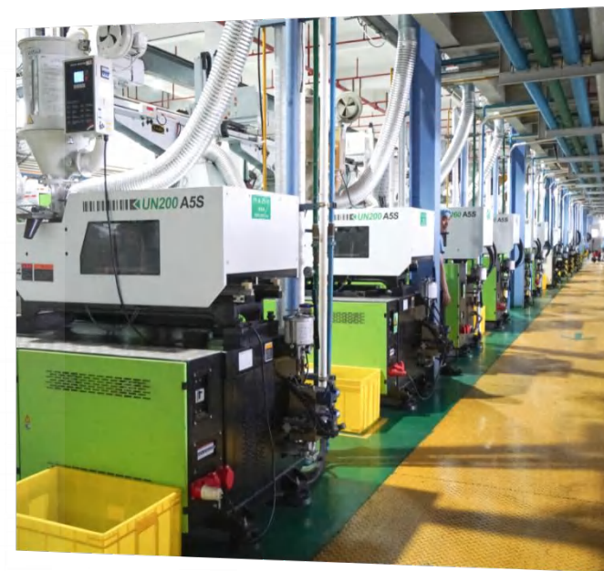
● 注塑配中央供料系统 原材料与生产现场分离
